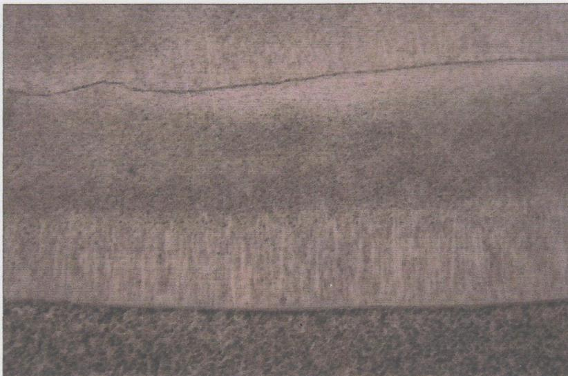
*Bild 2. Metallographischer Schliff durch eine elektrochemisch aufgebaute Reparaturbeschichtung*
